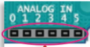
**Pinos 0 a 5:** esses 6 pinos aceitam tensões entre zero e 5 volts *CC* que vão ao conversor *A/D* de 10 bits no microcontrolador do Arduino. O pino *AREF*, numa das barras de pinos digitais, é a entrada de tensão de referência para esse conversor.
