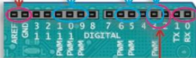
**Pinos 0 e 1:** os dois primeiros pinos digitais são conectados a USART do microcontrolador do Arduino para comunicação serial com um computador.
