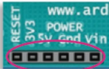
**Pinos 3V3, 5V e Gnd:** dos 6 pinos dessa barra somente os quatro do meio servem para alimentar um circuito externo conectado ao Arduino: o pino de 5V e o terra (os dois pinos Gnd entre 5V e Vin); e o pino 3V3 que disponibiliza essa tensão com uma corrente máxima de 50mA.
